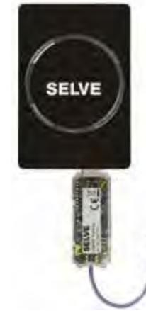
Ein kleines Gerät mit dem sich Rollläden von jedem Ort aus steuern lassen. Es reicht aus das Bediengerät mit Hilfe einer Smartphone App über WLAN oder Internet anzuschließen.
